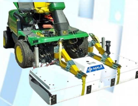
Georadar MIRA (MALA Imaging Radar Array) para mapeado 3D de construcciones
